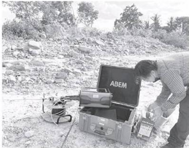
PERSEDIAAN: Hardianshah membuat persediaan alat bagi membuat penylasatan keberintangan bumi di lapangan.
