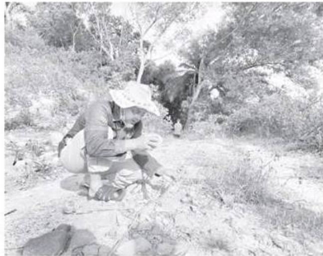
PEMASANGAN: Kawi memasang elektrod semasa proses kajian sumber air bawah tanah menggunakan teknik pengukuran keberintangan bumi.
