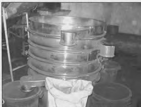
Rajah 2.1: Mesin pengasing bagi serbuk teh yang telah siap diproses yang digunakan untuk tujuan penggredan oleh kilang pemprosesan teh, Sabah Tea Sdn Bhd.
