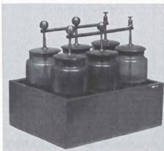
Rajah 2.1 (b) Sambungan beberapa buah balang Leyden untuk menghasilkan bateri
