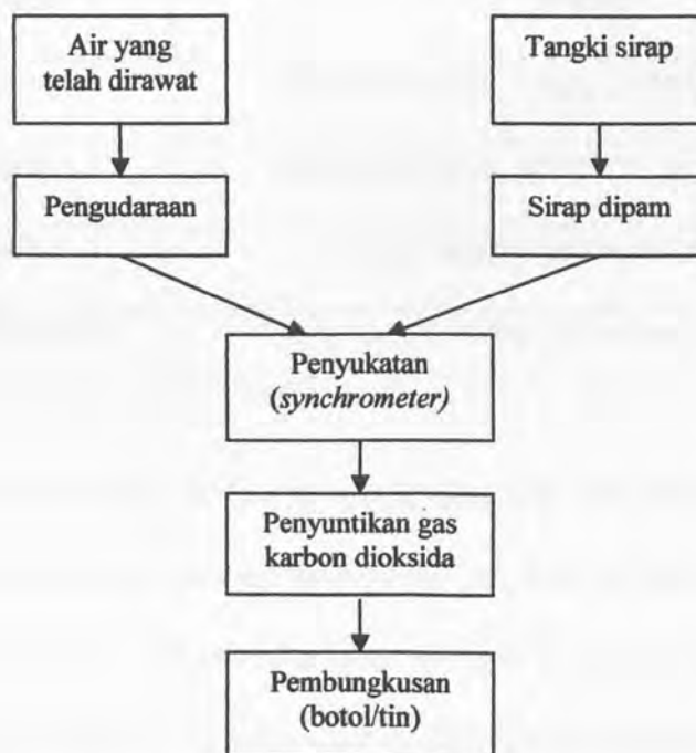
Rajah 2.1 Proses penghasilan minuman ringan berkarbonat secara ringkas.
